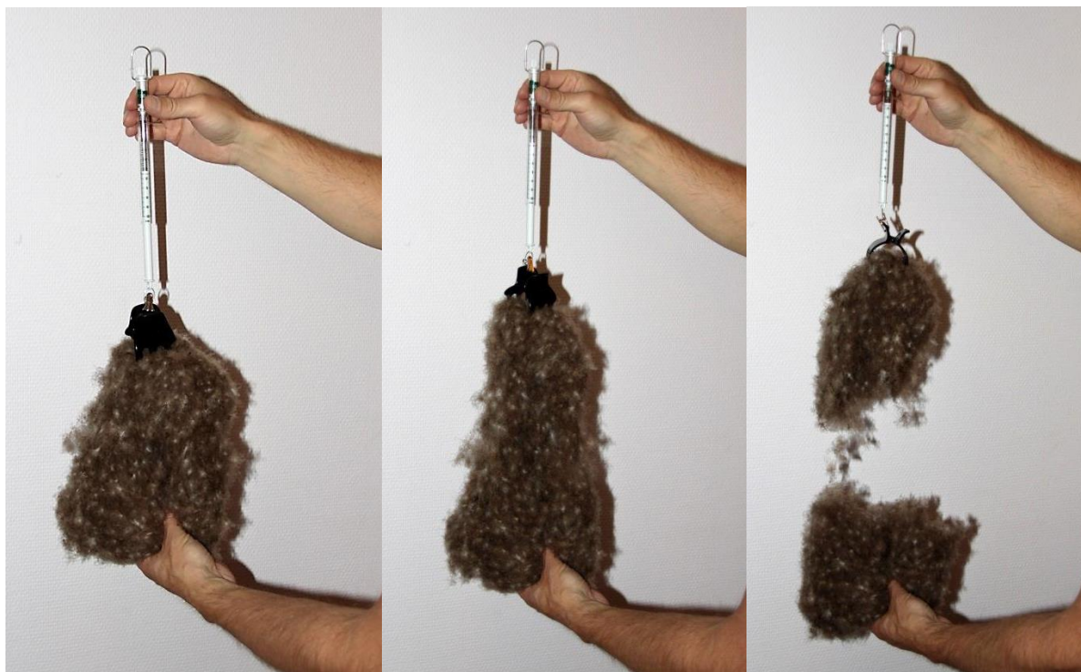
Bilde 25: Bildefølge som viser hvordan strekktesten ble foretatt. 10 gram dun er festet til en hårklype (13,8 gram) som er festet til en fjærvekt. Maksimal kraft avleses på det første bildet (t.v.) før dundotten begynner å dele seg i to (midterste bilde). På bildet til høyre har sammenhengskraften blitt brutt.
